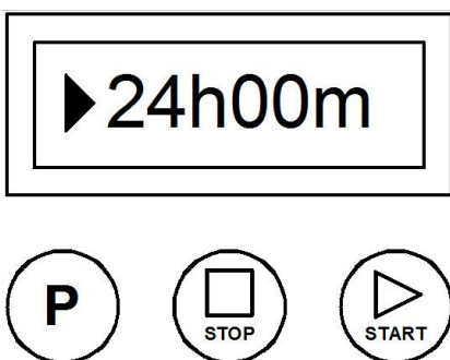
Рис. 2. В зависимости от установок на экране появится предварительно установленное время работы кремовалки.
